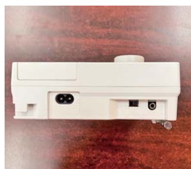
⑥ 本体右側のスイッチを切→入 電池交換完了
